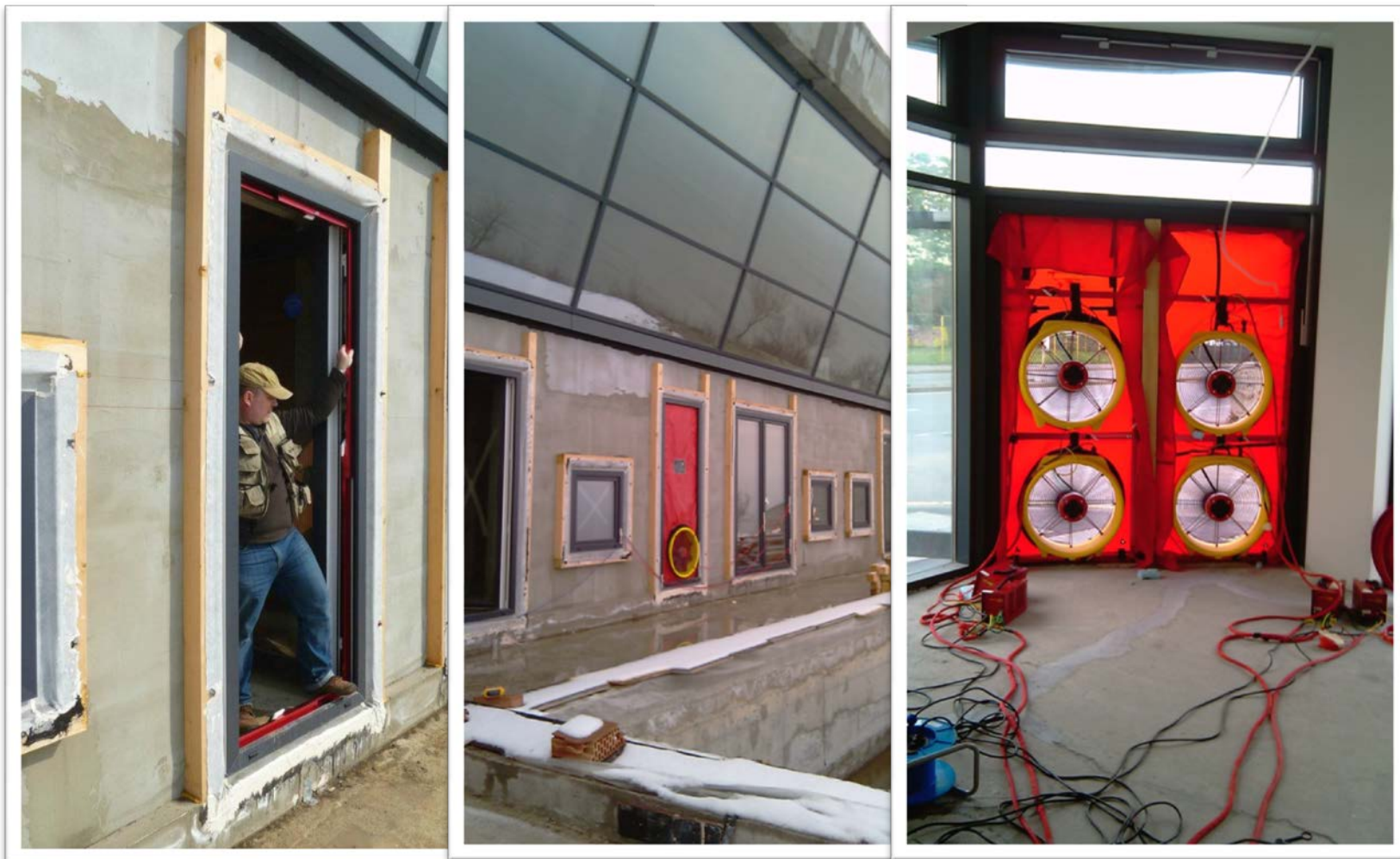
Инсталиране на Blower door установката
