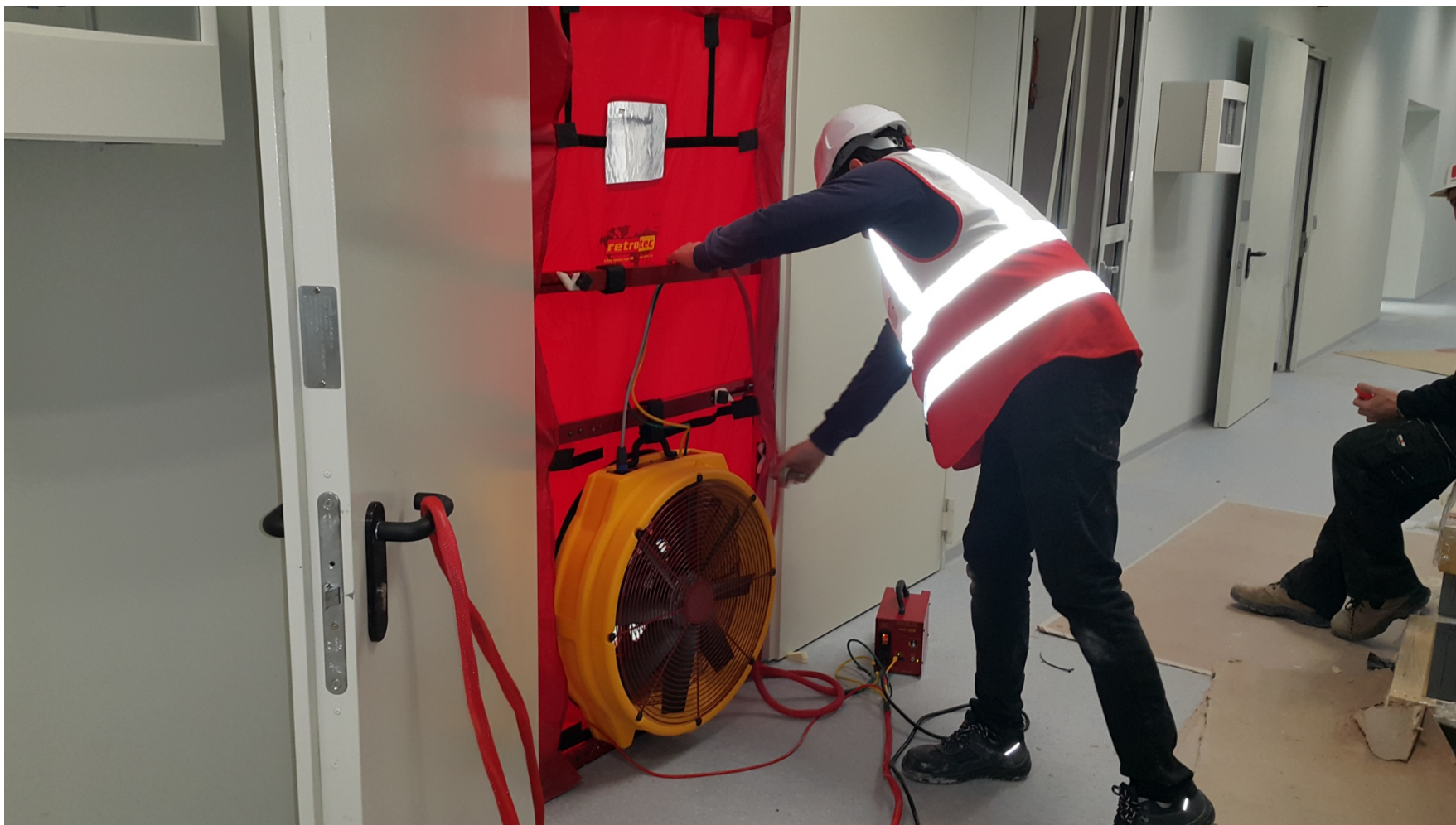
С Blower door технологията може да се тестват и пожарогасене на сървърни помещения – Door fan test
